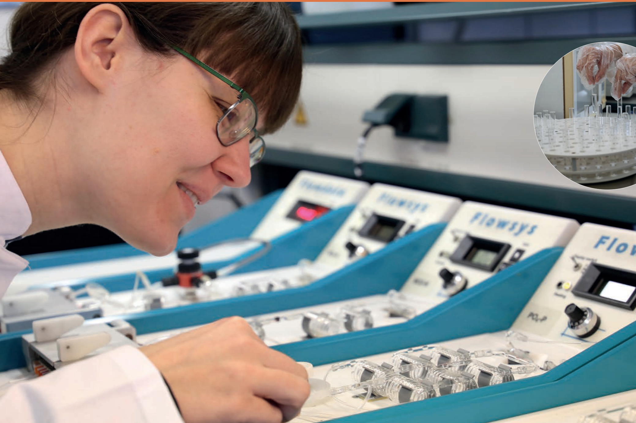
Madleen Dierken misst Nährstoffe in Ostseeproben am sogenannten Continuous-Flow Analyzer (CFA), das nasschemische Proben automatisch ermittelt. Foto: K. Beck, IOW Kleines Foto: Apparatur mit Proben zur Messung von gelöstem organischen Kohlenstoff. Foto: IOW
