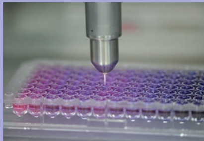
Ein Plasmastift im Einsatz bei einem medizinischen Testaufbau. Das Doktorandennetzwerk plasmACT erforscht den Einsatz von Plasma bei aktinischer Keratose. Foto: INP
