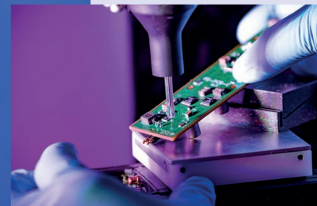
Kleines Bild: Mit einem Plasmastrahl kann SurfAP 3 winzige Strukturen in der Breite eines menschlichen Haares herstellen, beispielsweise für Anwendungen in der Mikroelektronik, Mikrofluidik oder Bioelektronik. Foto: INP
