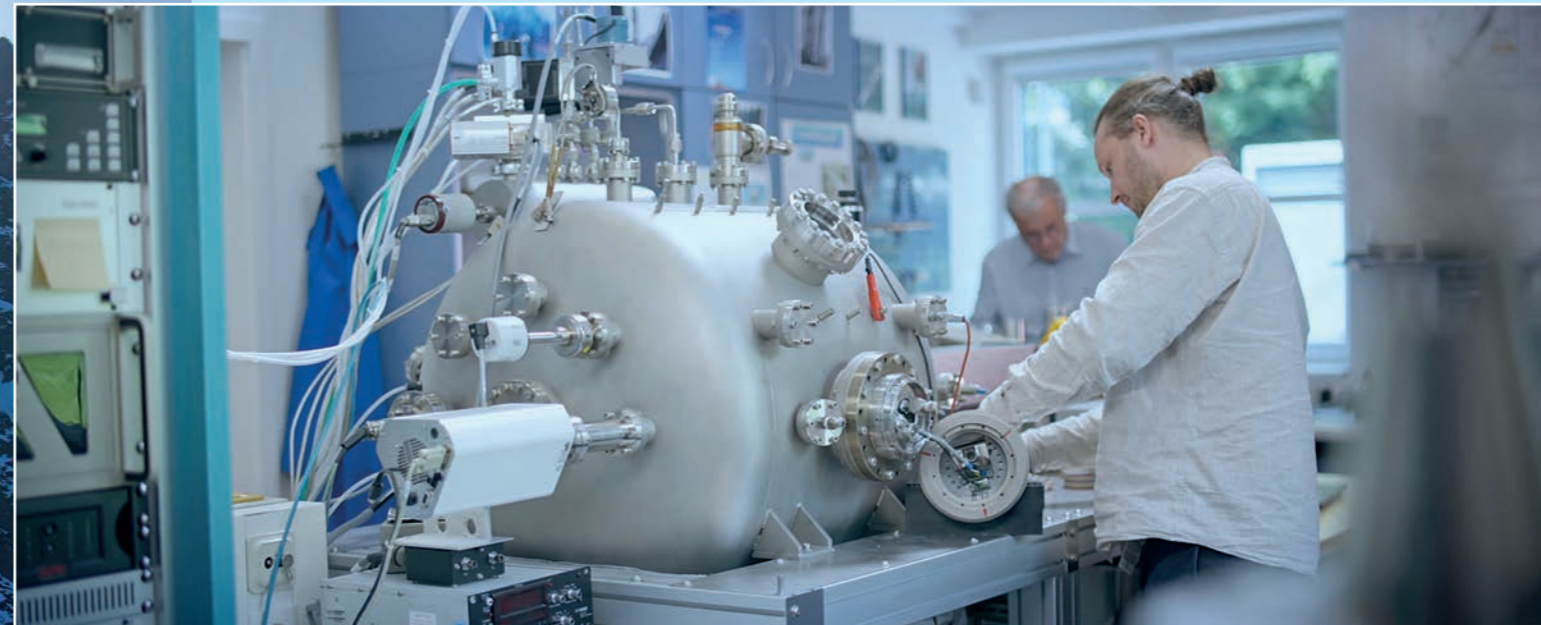
Hans-Jürgen Heckl und Tristan Staszak (vorn) bei Arbeiten im Vakuum- und Plasmalabor. Hier werden Sensoren für Messungen auf Höhenforschungsraketen entwickelt, getestet und kalibriert. Foto: IAP
